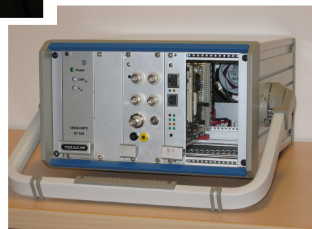
Abb.2 (rechts): Von den ARCS entwickelte Kryptographie - Elektronik. Das System ermöglicht voll automatische Generierung eines Schlüssels aus verteilten Photonendetektionsereignissen. Es läuft auf einem eingebetteten Linux System.
