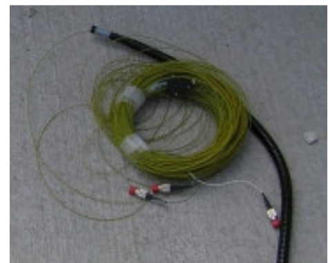
Abb.5 (unten): Über eine Glasfaser werden Einzelphotonen gesendet, 3 weitere Glasfasern dienen zur Synchronisation und klassischen Kommunikation zwischen den Parteien.
